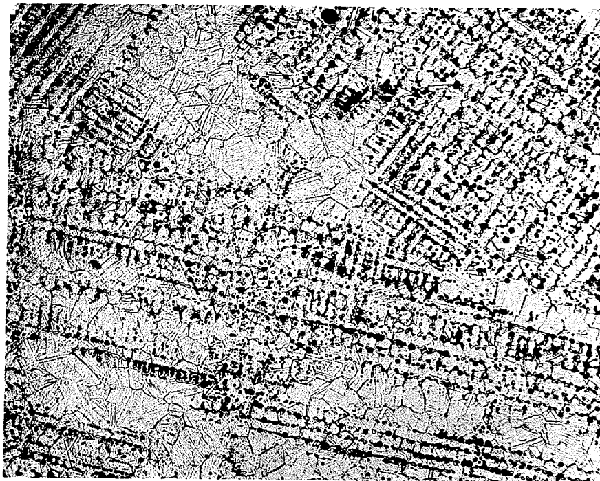
Fig. 45 Co - 25%Cr - 5%Nb X100 1423 K 96 hrs.
