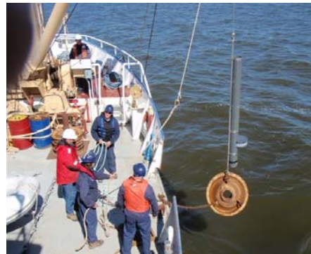
Installation d'un piège à sédiments séquentiel depuis le NM Namao . Photo : Todd Breedon. © Environnement Canada 2009
