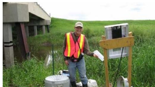
Station de surveillance en berge pour mesurer le ruissellement des nutriments. Photo : Julie Corriveau. © Environnement Canada 2009
