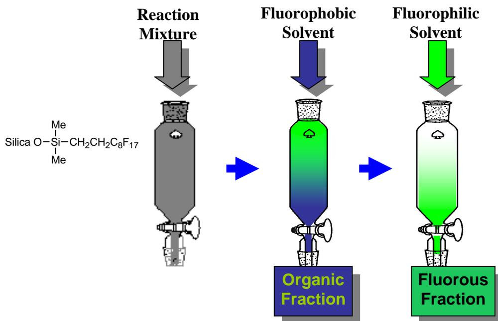
**Figure 1.3.2.1:** F-SPE separation technique.
