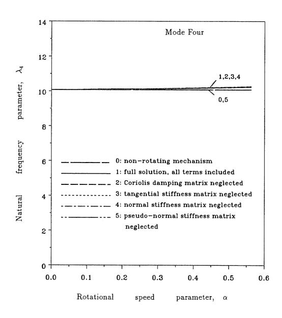
Figure 3.13: Natural frequency parameter vs. rotational speed parameter
