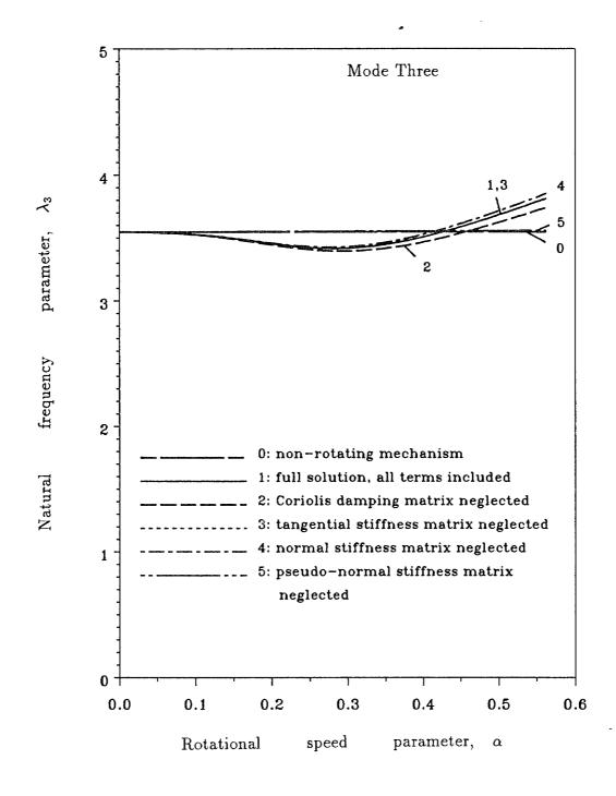
Figure 3.12: Natural frequency parameter vs. rotational speed parameter
