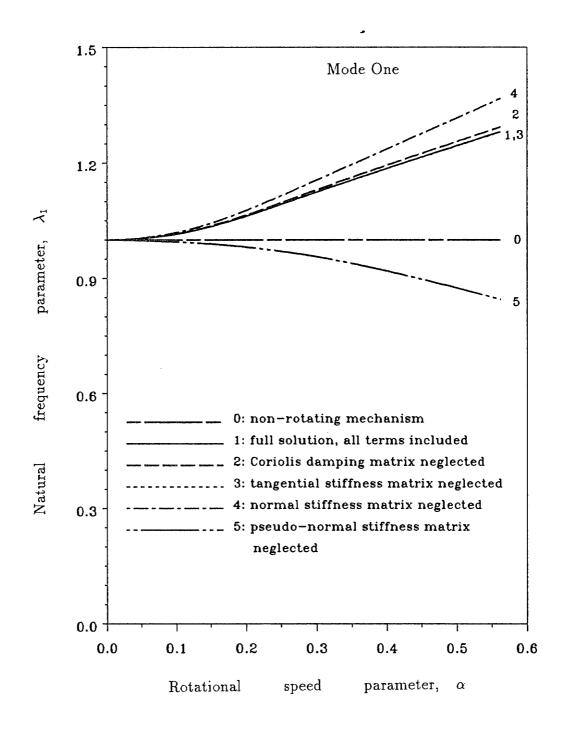
Figure 3.10: Natural frequency parameter vs. rotational speed parameter
