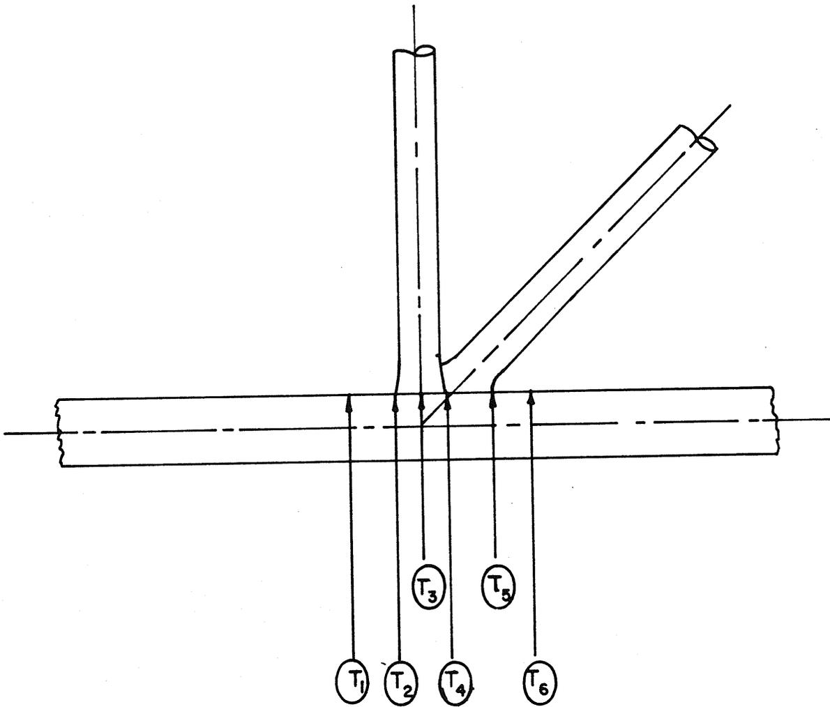
FIG. 3.10 TRANSDUCER LOCATION
