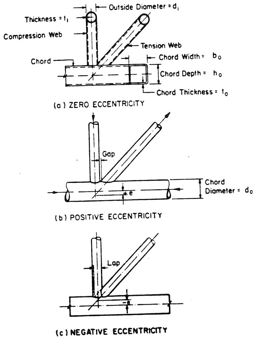
FIG. 2.1 PARAMETERS AFFECTING JOINT BEHAVIOR
